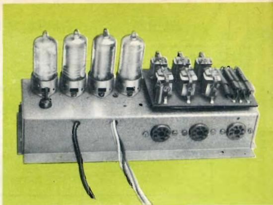
Fig. 5 - L'apparato ricevente. Notare a sinistra in primo piano il gambo del nucleo in ferrite per la regolazione della sintonia. A destra i sei relais ed un gruppo di condensatori (non riportati nello schema) applicati in parallelo ai contatti dei relais stessi per assorbire le extracorrenti di apertura.
