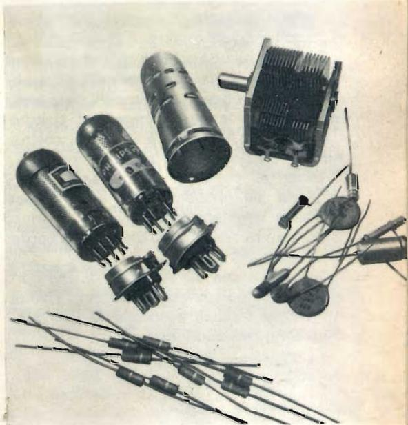
Gran parte di questi ingombranti componenti verranno eliminati con l'introduzione del **Varicap** e del **Diodo di Esaki**.
